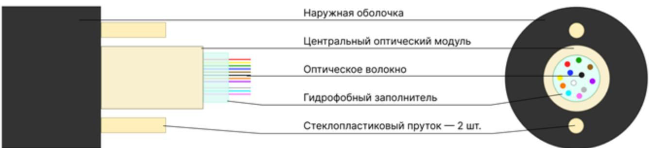
Кабель с центральным оптическим модулем (ЦОМ) из ПБТ, который содержит от 1 до 24 свободно уложенных оптических волокон (ОВ). Каждое волокно имеет индивидуальную акриловую оболочку и расцветку. Свободное пространство ЦОМ заполнено внутримодульным гидрофобным заполнителем. На ЦОМ накладывается наружная оболочка из полиэтилена средней или высокой плотности. В качестве периферийных силовых элементов используются 2 стеклопластиковых прутка, которые расположены продольно ЦОМу и впаяны в оболочку.
